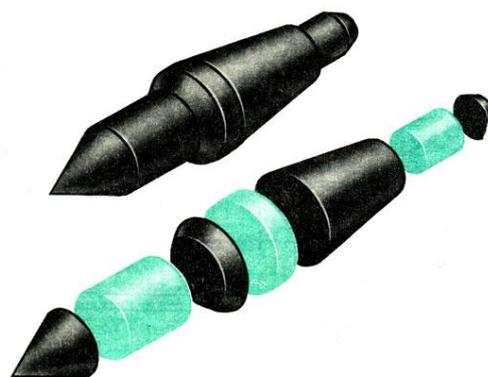
Рисунок 21 – Анализ формы центра токарного станка
