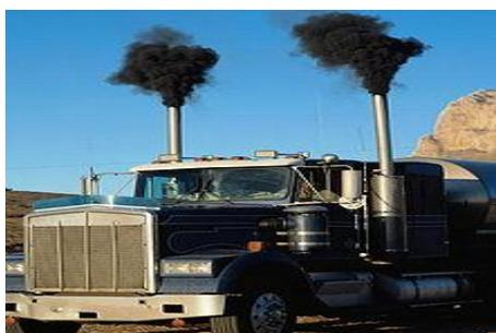
Выхлопные газы - отработавшее в двигателе рабочее тело. Являются продуктами окисления и неполного сгорания углеводородного топлива. [фото 10]
