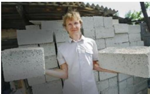
Рис.4 Каменные блоки, изготовленные из каменных строительных отходов.
