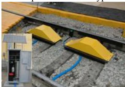
Система мониторинга КТСМ размещается в шкафу управления рельсосмазывателя. Рельсосмазыватель, оборудованный КТСМ, передает информацию о количестве расходных материалов (давление, напряжение батареи, наличие смазки), о количестве осей, о режимах и установках, номер шкафа и др. Передача информации осуществляется автоматически с задаваемой периодичностью (минимальная периодичность - каждый день, максимальная - каждая неделя).
