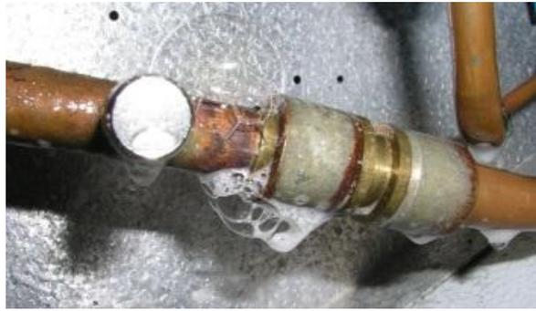
Мыльный раствор применяется в том случае, когда с высокой степенью вероятности известна область возникновения утечки. Например, эта область определена электронным течеискателем.
