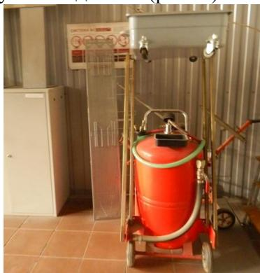
Рисунок 6 Оборудование для проведения заправочно-смазочных работ
