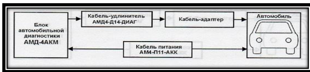
Схема подключения кабеля АМД4-Д14-ДИАГ
